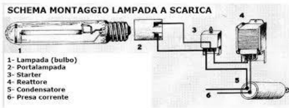
Infatti, la presenza degli avvolgimenti dell'alimentatore ferromagnetico rende il carico di tipo "induttivo", per cui si rende necessario effettuare un rifasamento di Roseto degli Abruzzi stesso attraverso una capacità.
